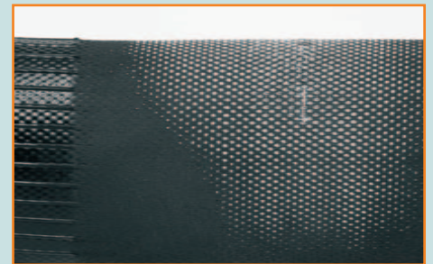
FORMAT Mehrzweckschlauch (nach 1.500 Zyklen) Die Gummidecke ist großflächig abgeschürft. Das Gewebe ist gerissen und der Schlauch ist somit undicht geworden.
