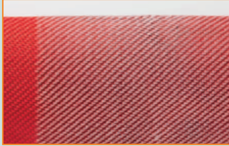
Feuerlöschschlauch nach DIN 14811 mit roter Außenbeschichtung aus Polyurethan Ein deutlich besseres, jedoch nicht zufrieden stellendes Ergebnis. Angerissenes Gewebe nach 250 Zyklen.
