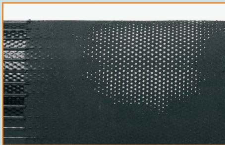
FORMAT Mehrzweckschlauch (nach 300 Zyklen) Die Rippen sind abgeschürft. Das Gewebe ist an einzelnen Stellen sichtbar.
